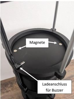
Zusätzlich können mit dem Tragegestell mehrere Buzzer gleichzeitig geladen werden. Stellen Sie hierzu die Buzzer in das Gestell und verbinden Sie die jeweiligen Stecker mit dem Buzzer. Verbinden Sie nun das Ladegerät mit dem Ladeanschluss des Tragegestells. Weitere Informationen zum Thema Laden finden Sie im Kapitel 3.5. Laden des Buzzers.
