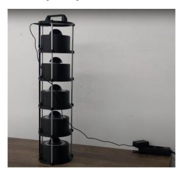
Stellen Sie den Buzzer in eine Etage und drehen Sie ihn, bis er von der Magnetkraft gehalten wird. Dabei befindet sich der Ladeanschluss des Buzzers genau bei der Aussparung der Etage. Verbinden Sie nun die jeweiligen Stecker des Tragegestells mit den Buzzern.
